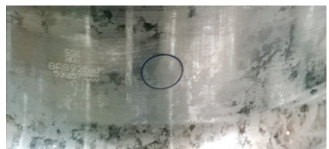
Abbildung 13-5 Hitzeindikator Version 2 am Tiefbett des Rades in der Nähe der Seriennummer und des Ventillochs
