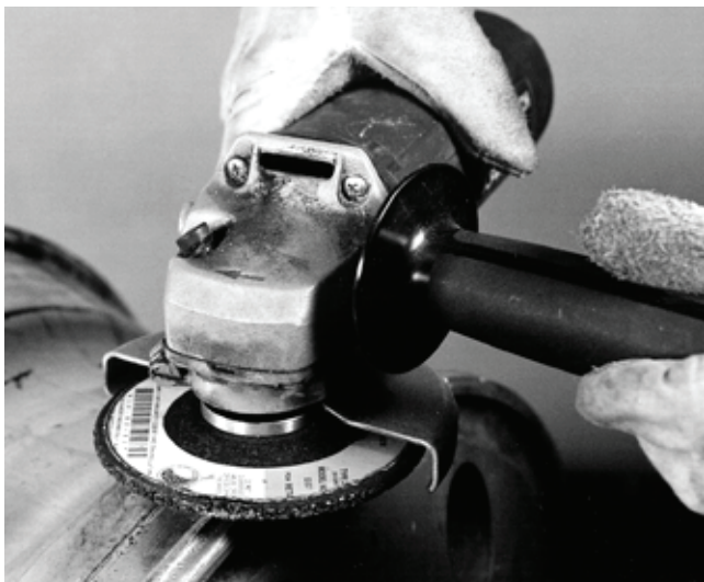
Abbildung 13-33 Winkelschleifer Diese Variante einer elektrischen Schleifmaschine wird mit einer Schleifscheibe, einem Schleifstein oder einem Schleifwerkzeug benutzt. Dieses Werkzeug arbeitet ebenfalls sehr schnell und effektiv. Tragen Sie das Metall so gleichmäßig wie möglich ab und schleifen Sie nicht in das Rad.
