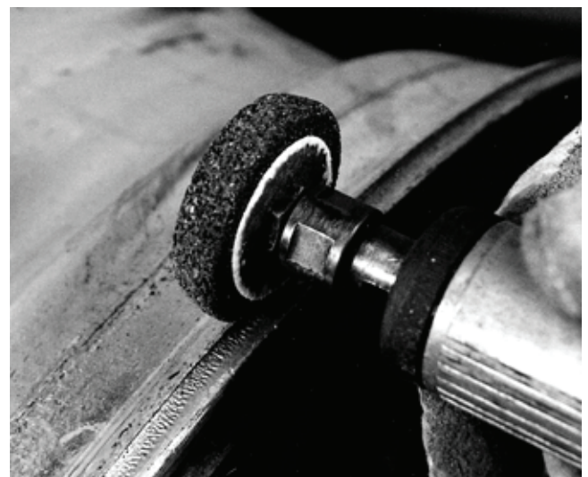
Abbildung 13-32 Pneumatische oder elektrische Schleifmaschine Eine weitere schnelle und effektive Methode, um scharfe Kanten am Felgenhorn als Folge von Felgenhornverschleiß zu entfernen. Achtung: Die Schleifkörper können sich durch das entfernte Aluminium zusetzen. Vermeiden Sie es, zu tief in das Rad zu schleifen.
